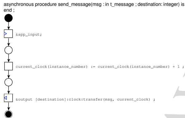
FIG. 34 – Diagramme de comportement de la méthode send_message de la classe clock
